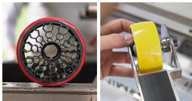
Rad mit Wabenform (l) und Prototyp mit Scheibenbremsprinzip (r).
