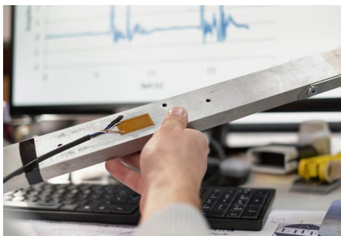
Das Übertragen von Daten wird durch einen Piezosensor möglich.
