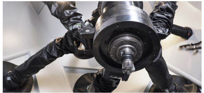
Blick in den Bearbeitungsraum: Der Roboter mit seinen fünf Achsen, in dessen Spannsystem je nach Anwendung ein Fräswerkzeug oder eine Einheit für additive Fertigung eingewechselt werden kann.
