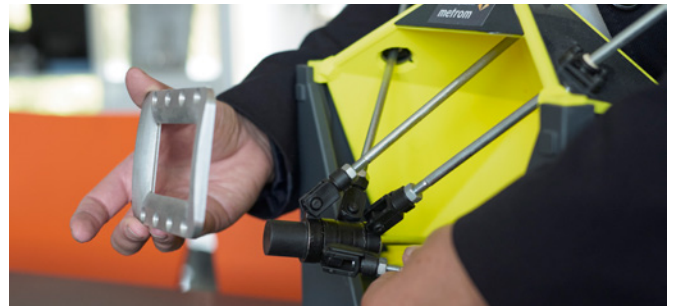
Durch die 5-Achsigkeit ist ein schnelles und einfaches Einmessen des Bauteils möglich.
