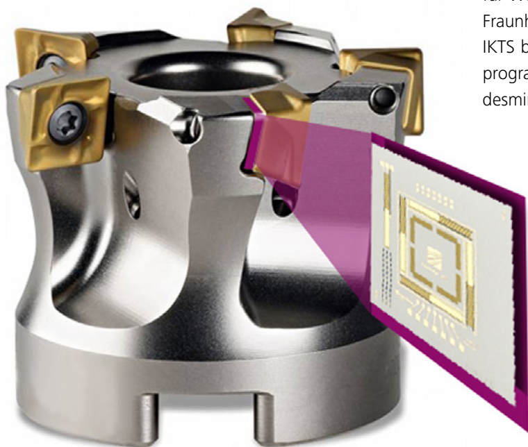
Wirkstellennahe Erfassung von Prozessgrößen an rotierenden Werkzeugen
